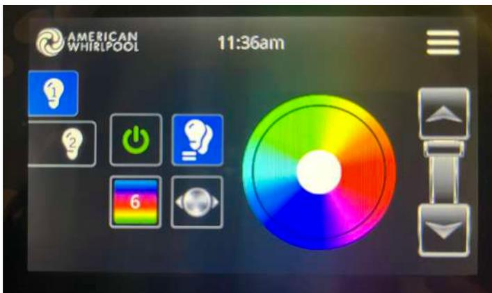
Par défaut, in.mix sélectionne la zone 1 lorsque vous accédez au menu. Pour verrouiller les deux zones ensemble, appuyez sur le bouton avec les deux ampoules. Pour déverrouiller les deux zones, appuyez à nouveau sur le même bouton. Sinon, réglez chaque zone en sélectionnant le numéro approprié sur le côté gauche.
