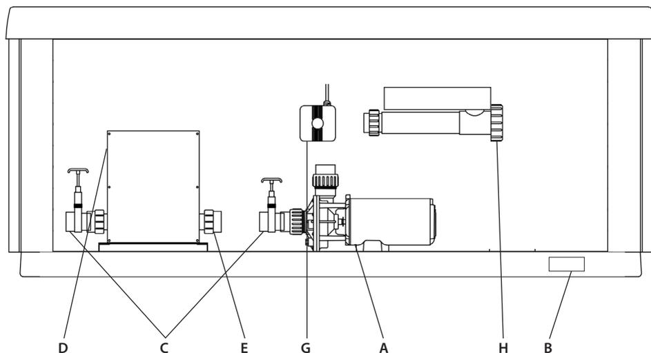
**A. Pompes (une ou plusieurs pompes, selon le modèle) :** faible vitesse pour une circulation de l'eau efficace pendant la filtration et le chauffage ; haute vitesse pour un fonctionnement maximal des jets. Les fonctions de la pompe sont activées depuis le panneau de commandes supérieur.
